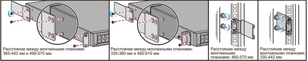
**S5731-H S5731-H-K S5731-S S5731S-S S5731S-H S5732-H S5732-H-K S5735-L (глубиной 420 мм) S5735S-L (глубиной 420 мм) S5735-S S5735S-S S6720-HI S6730-H S6730S-H S6730-H-K S6730-S S6730S-S**
