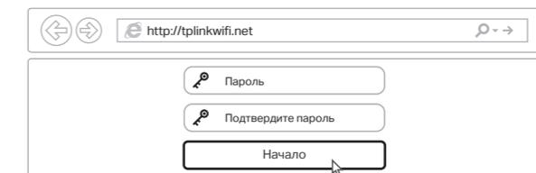
3. Запустите Быструю настройку, выберите Wi-Fi роутер и следуйте пошаговым инструкциям для настройки интернет-соединения.
