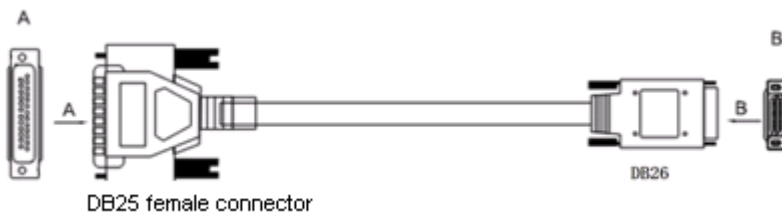
Figure 1-11 V.24 DCE Cable
